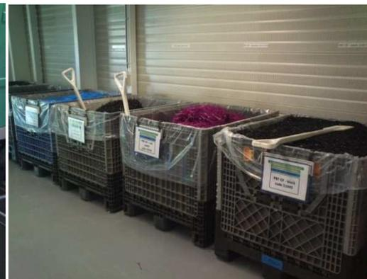
樹脂成型工程において生成されるランナー・打ち捨て品・不良品等樹脂を種類別に分別して回収し、外部業者に有価材として売却します。リサイクル業者が変わっても、2012年から大幅アップしているリサイクル材の売却額を維持しています。
